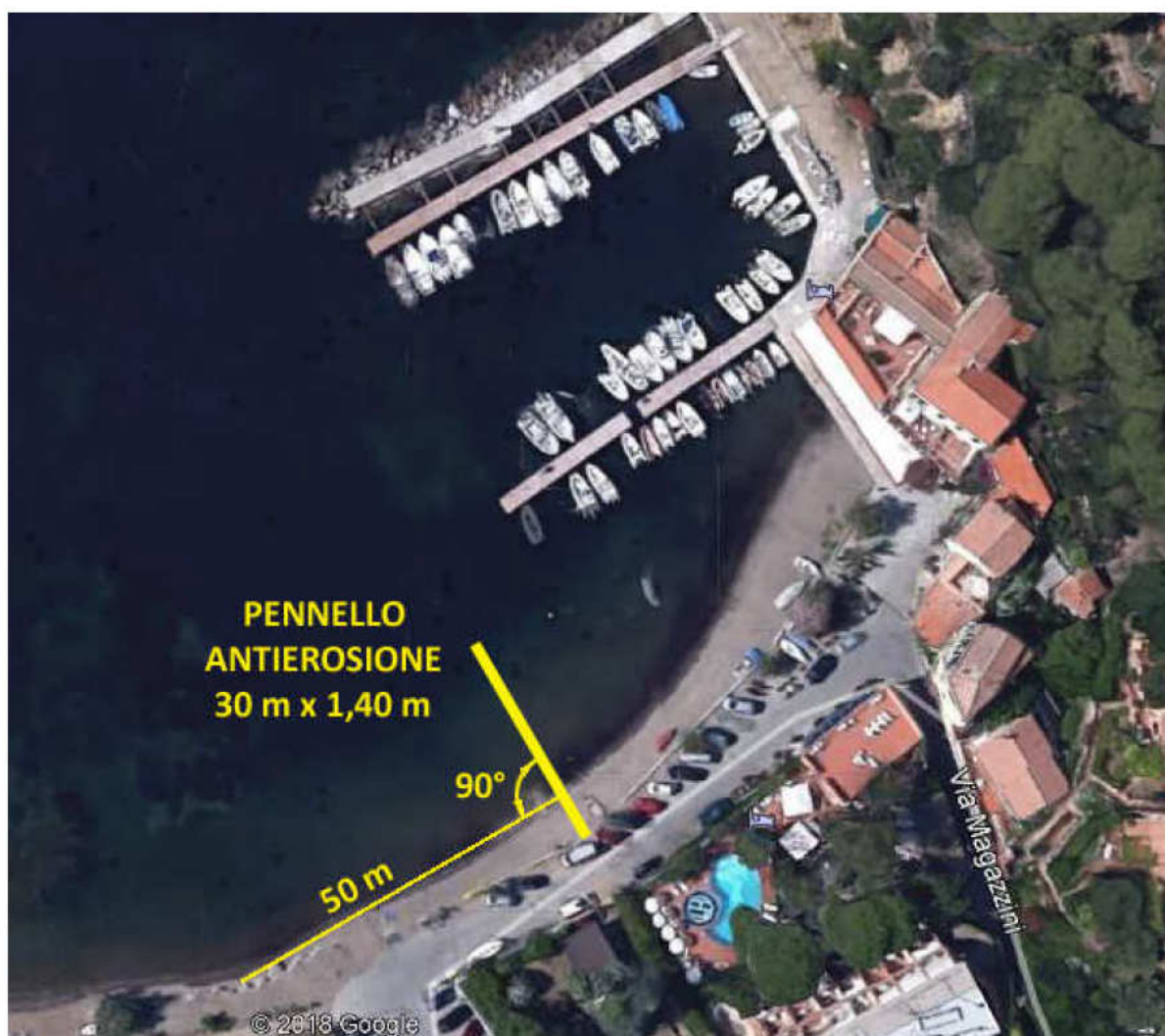
Fig. 3.1 – Magazzini - Molo di sottoflutto - Layout della soluzione progettuale (scala 1:1000). Il pennello è radicato subito a destra della radice del vecchio pennello, con l'asse orientato a 90° rispetto ai primi 50 m del tratto di spiaggia adiacente a sinistra, ossia a circa 330°N
